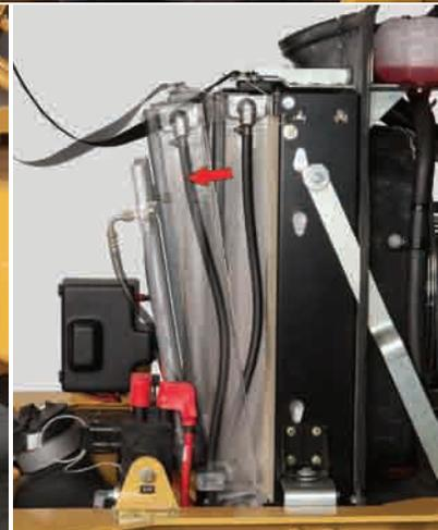
Accesso a livello del terreno, manutenzione dal lato destro della macchina e indicatori visivi sono solo alcune delle caratteristiche che rendono la manutenzione sulle macchine Cat più facile ed economica rispetto alle macchine della concorrenza. I modelli CS44 e CP44 sono inoltre caratterizzati da un giunto di articolazione esente da manutenzione e da uno scambiatore di calore dell'olio inclinabile per facilitare l'accesso durante le operazioni di assistenza.
